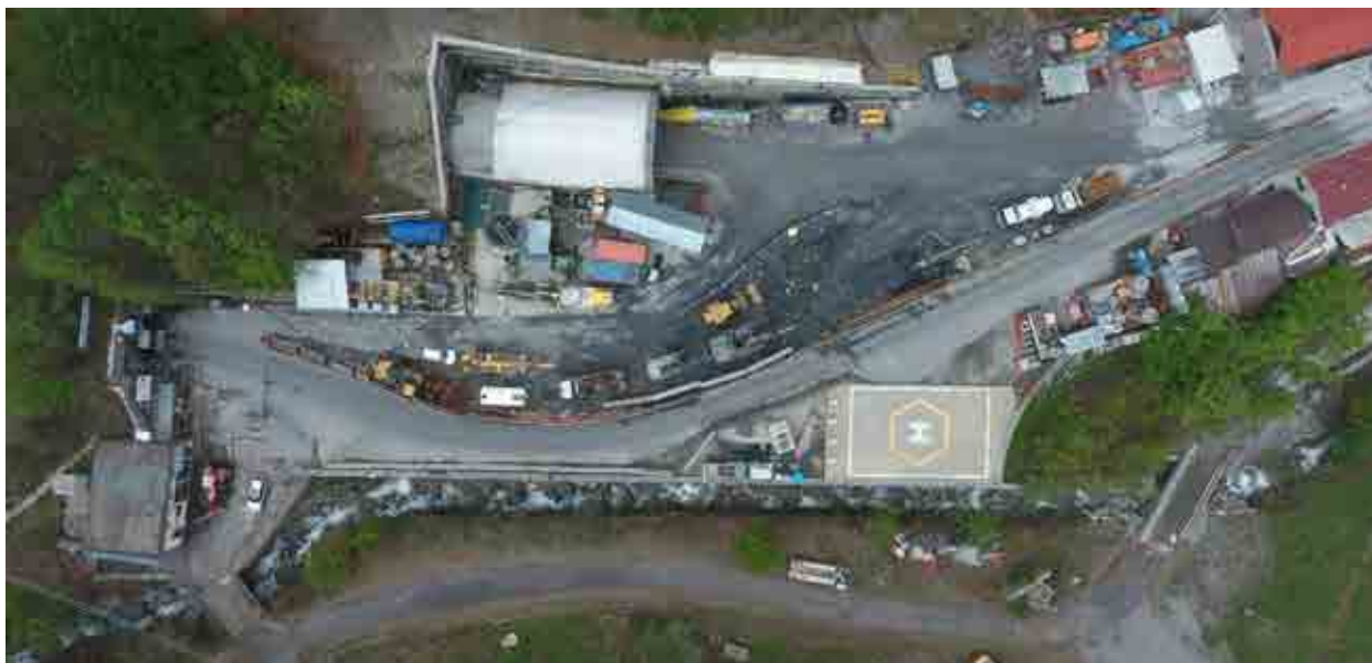
Figura 17 – Tratto di intervento nelle condizioni ante evento Alex, con dettaglio della geometria incanalata dell'alveo del rio Panice, costretto tra il muraglione in sinistra e un muretto in pietra subverticale in destra. L'impostazione progettuale attuale prevede invece di ampliare la larghezza di base dell'alveo (circa 5 m a partire dal taglione al piede del muraglione) realizzando poi una scarpata destra in materiale d'alveo (che comprende anche clasti di dimensioni medio-grandi) a modesta pendenza (x:y=2:1).
