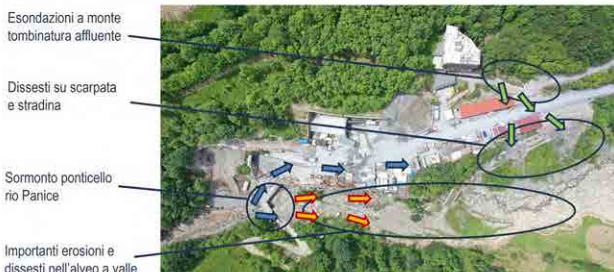
Figura 21 – Principali dinamiche di dissesto a seguito del sormonto del ponticello sul rio Panice nel corso dell'evento Alex
